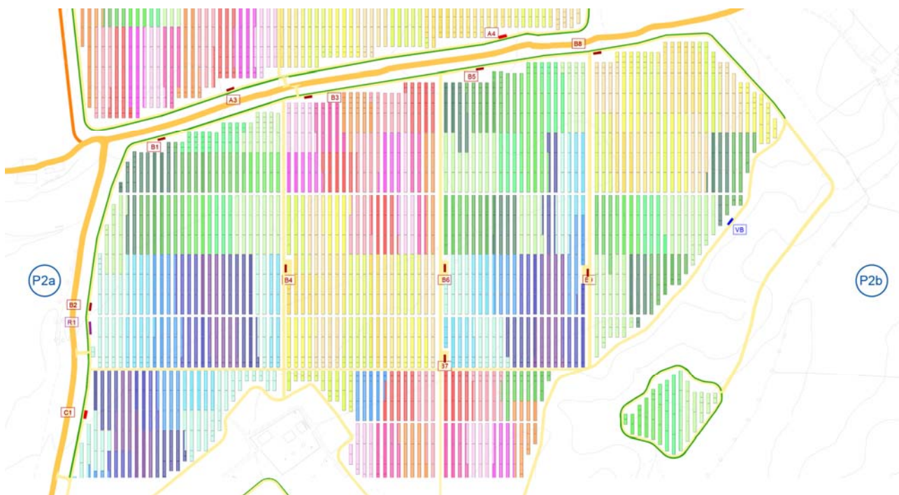
Figura 4- Particolare schema di suddivisione stringhe area centrale impianto
