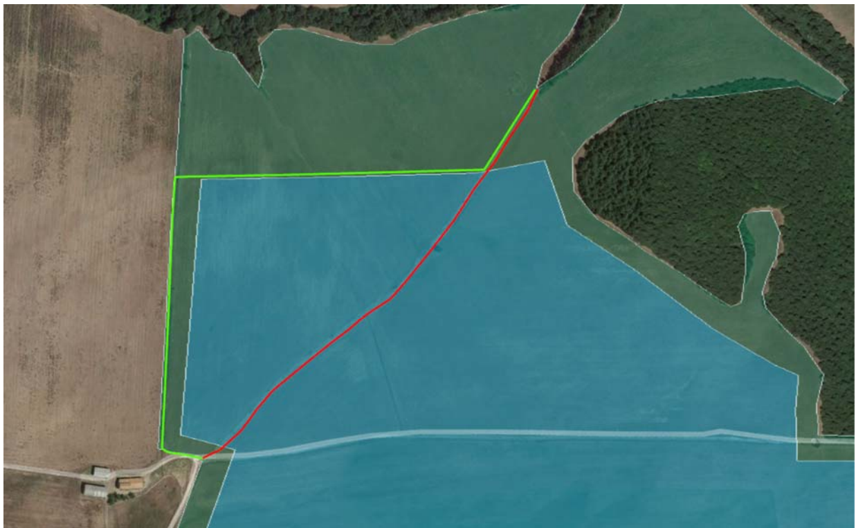
Figura 15 – schema tracciato aereo BT esistente e indicazione nuovo tracciato interrato (verde)
