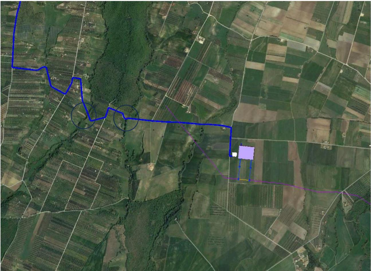
*Figura 12 - Ultimo tratto dell'elettrodotto (attraversamenti in TOC)*
