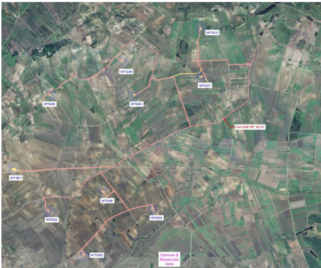
Figura 3.1 Inquadramento generale da ortofoto – impianto eolico
