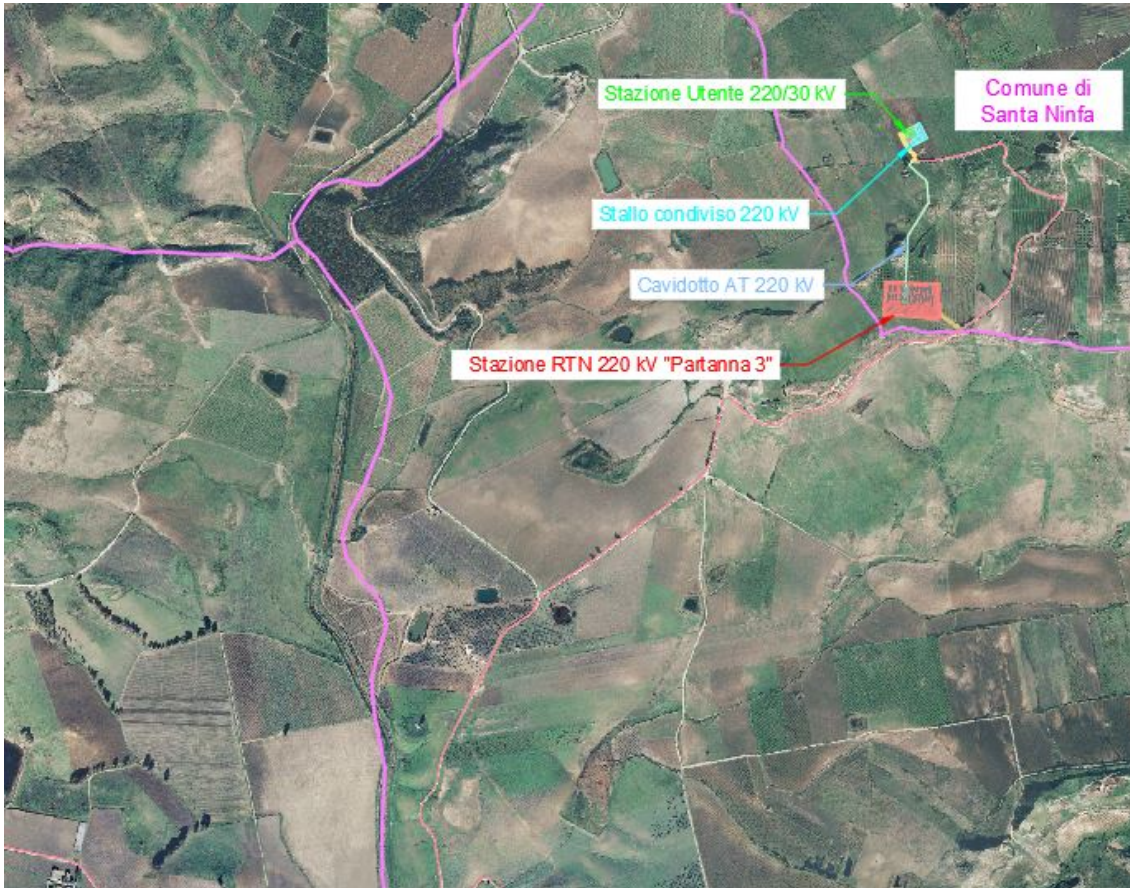
Figura 3.2 Inquadramento generale da ortofoto – opere di connessione
