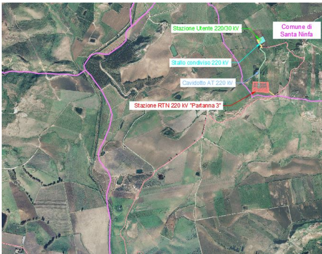
Figura 3.2 Inquadramento generale da ortofoto – opere di connessione
