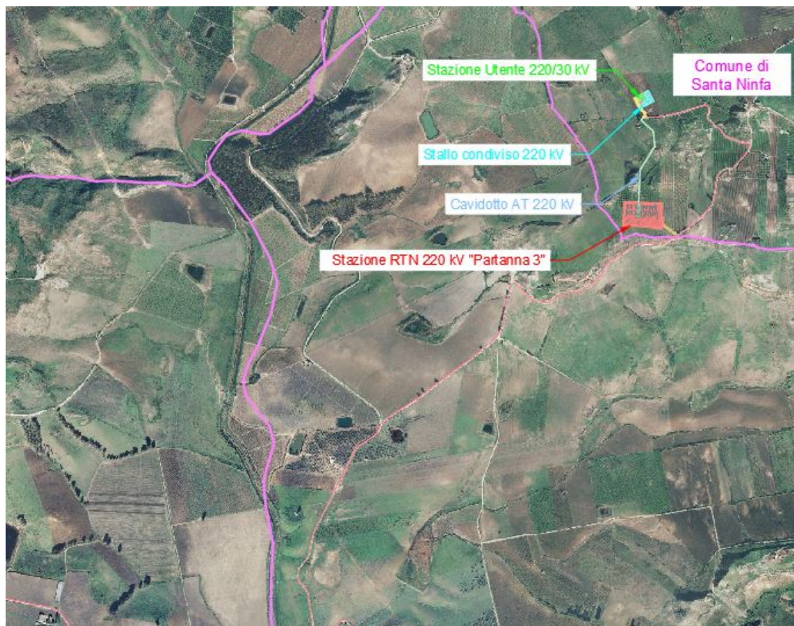
Figura 3.2 Inquadramento generale da ortofoto – opere di connessione
