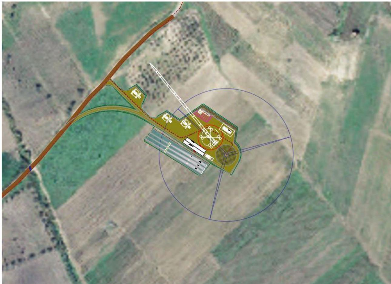
Figura 5.2 Planimetria di cantierizzazione - Piazzola aerogeneratore
