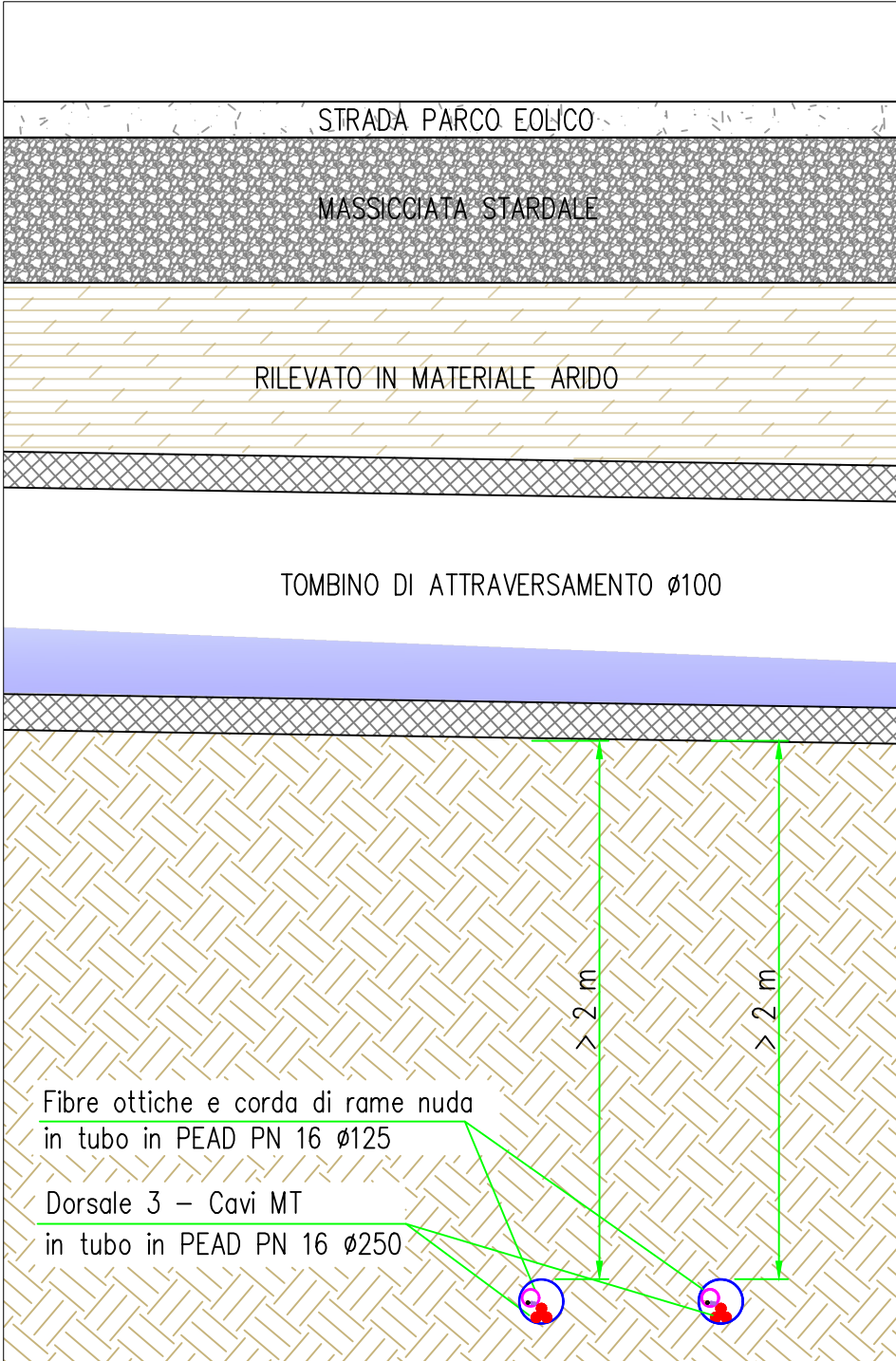
Dettaglio sezione trasversale - Scala 1:20
