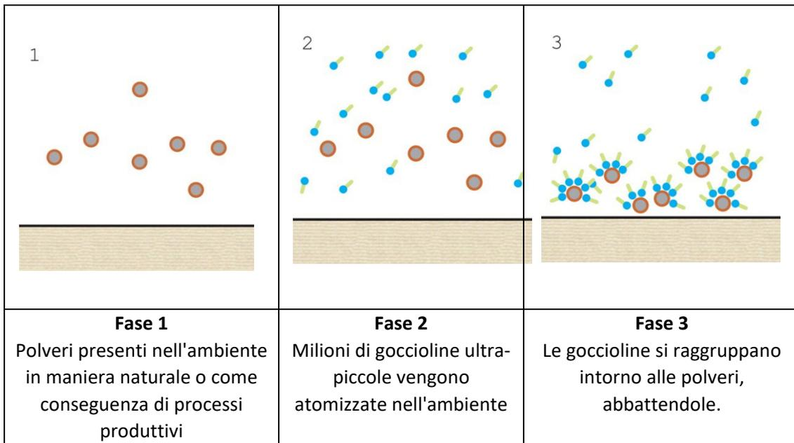
Figura 7.2 - Rappresentazione delle fasi di abbattimento delle particelle di polvere presenti nell'aria (Fonte: web)
