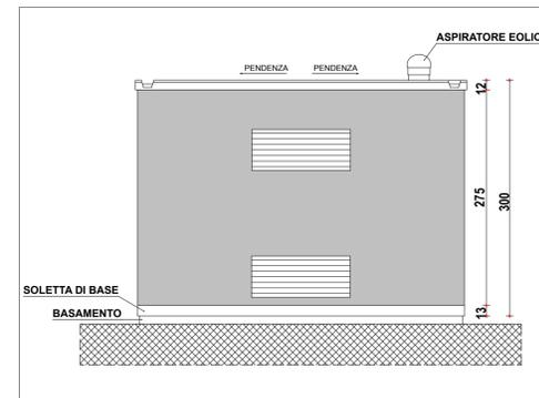
PROSPETTO LATERALE SINISTRO CABINA DI INTERFACCIA
