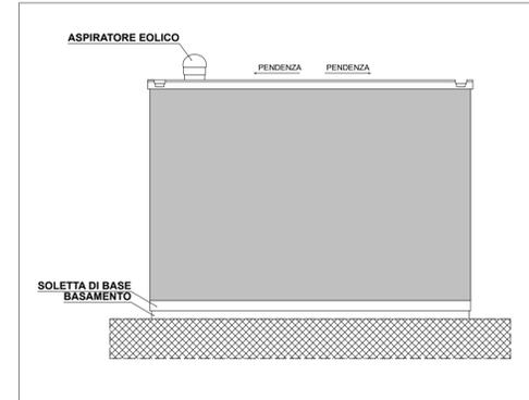
PROSPETTO LATERALE DESTRO CABINA DI INTERFACCIA
