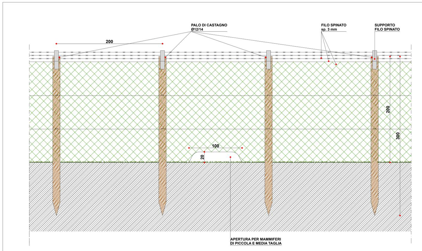
DETTAGLIO RECINZIONE - PROSPETTO SEZIONE FRONTALE
