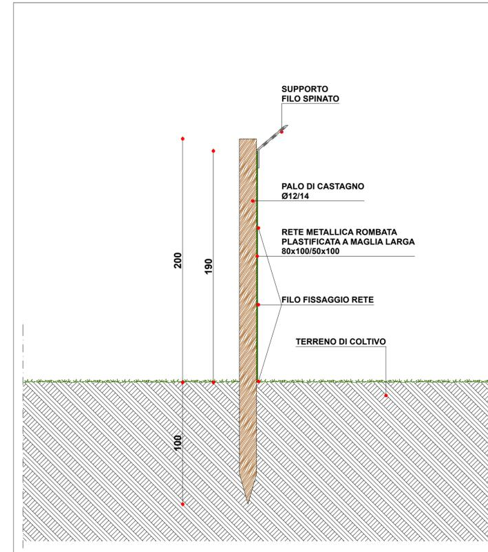
DETTAGLIO PALO IN LEGNO - PROSPETTO SEZIONE LATERALE
