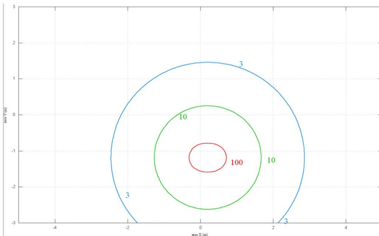
Lungo il tracciato dell'elettrodotto viene associata una fascia di rispetto di raggio pari a circa 2,5 m (arrotondamento al mezzo metro successivo) dal centro dello scavo, oltre la quale è garantito l'obiettivo di qualità di induzione magnetica inferiore ai 3  $\mu$ T.
