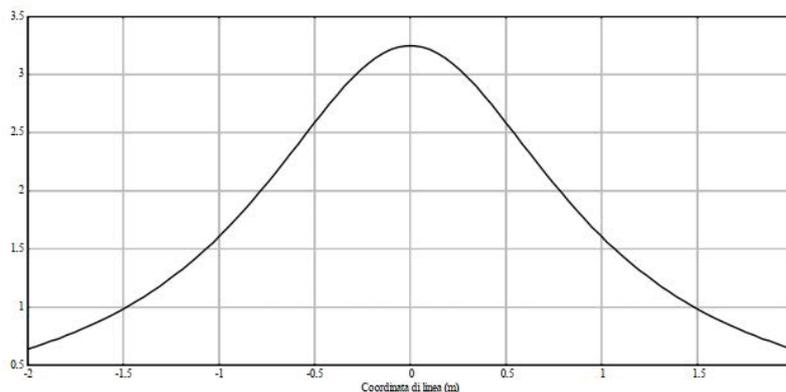
Si denota, come in corrispondenza dell'asse del cavidotto (x: 0 m), il valore si attesta attorno a 3,2  $\mu\text{T}$ , per poi decrescere simmetricamente su ambo i lati.
