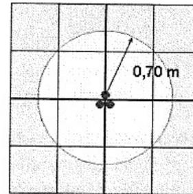
Fascia di rispetto (B > 3 microT) per cavo interrato MT ad elica visibile (passo d'elica 3 m) – sez. 185 mm<sup>2</sup> – In 324 A
