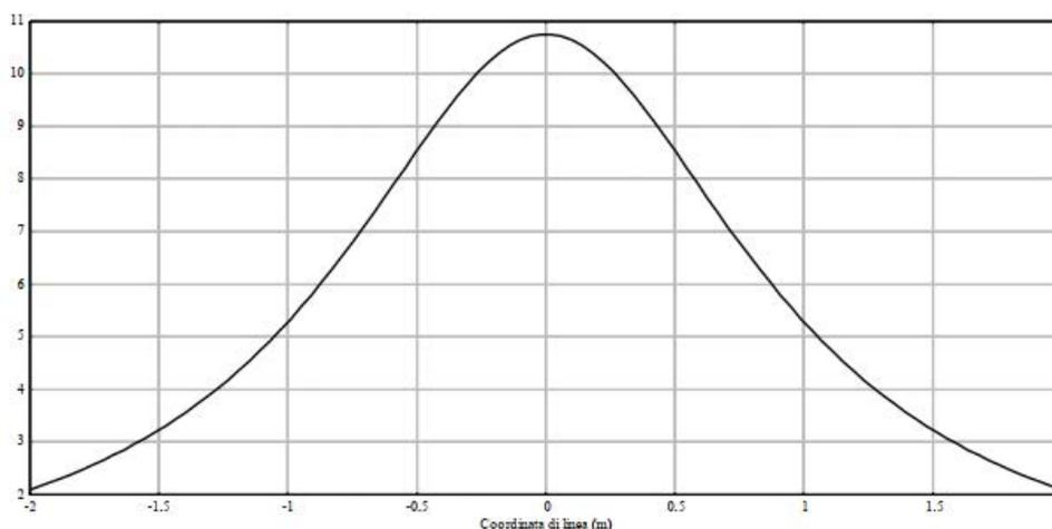
Si denota, come in corrispondenza dell'asse del cavidotto (x: 0 m), il valore si attesta attorno a 10,5 µT, per poi decrescere simmetricamente su ambo i lati, rimanendo sotto il valore di 3 µT nella fascia compresa da -1,6 e 1,6 m rispetto ad asse terna di cavi.
