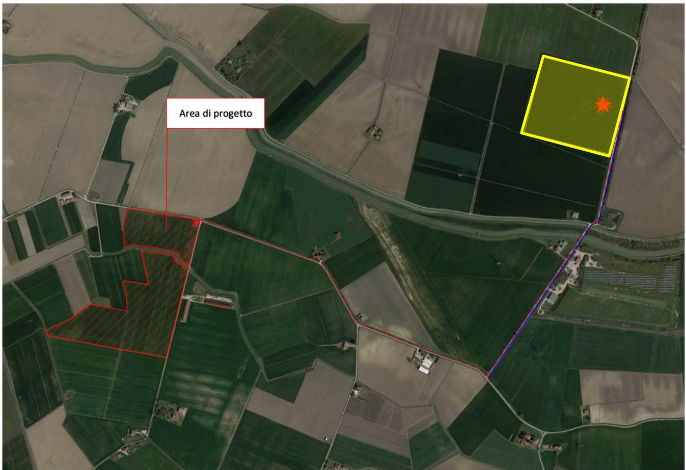
Nell'immagine satellitare di cui sopra, l'area occupata dall'impianto fotovoltaico è evidenziata in rosso, è indicata con una linea rossa l'elettrodotto interrato collegato in antenna a 36 kV sulla nuova Stazione Elettrica (SE) (in colore giallo) della RTN a 132/380 kV come indicato nella Soluzione Tecnica Minima Generale.
