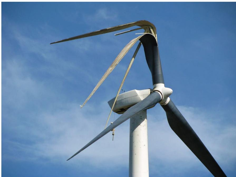
*Figura 4 - Turbina danneggiata da fulminazione atmosferica.*
