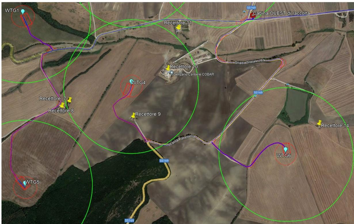
*Figura 12: Viabilità interessata dal rischio di gittata nell'area dell'impianto 3*
