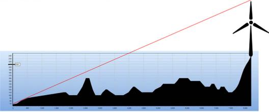
Turbina non visibile - sezione dal punto V8 alla turbina A9
