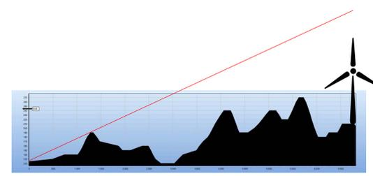
Turbina non visibile - sezione dal punto V7\_b alla turbina A1
