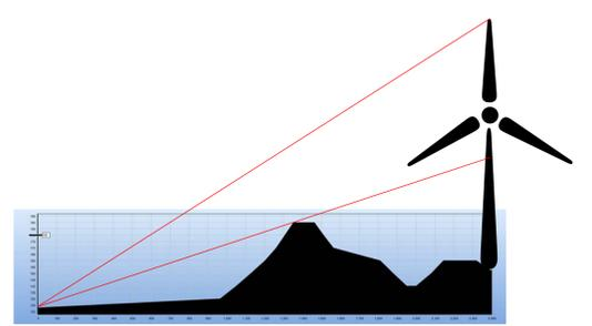
Turbina parzialmente visibile - sezione dal punto V7\_a alla turbina A10
