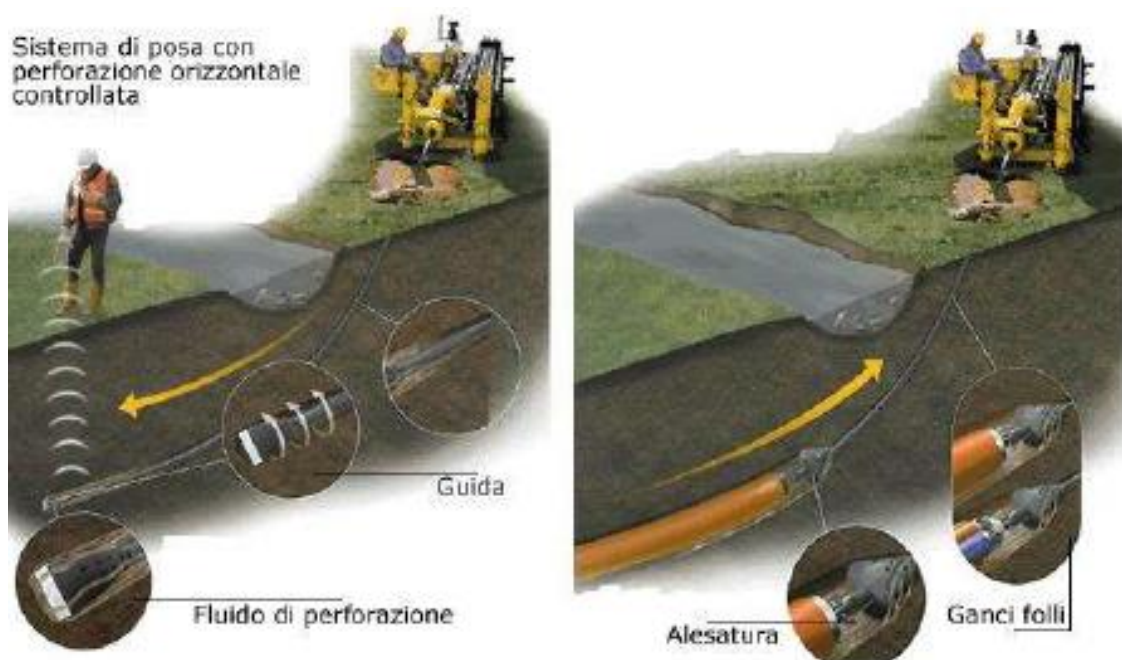
Posa in opera tubazione con trivellazione teleguidata
