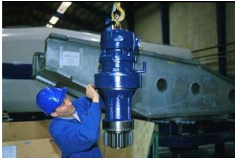
Figura 6 – Motori di giro e riduttori
