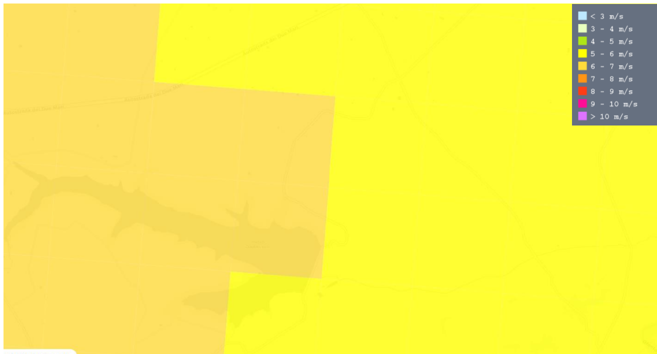
Mappe della velocità media annua del vento a 75 m e 100 m slm
