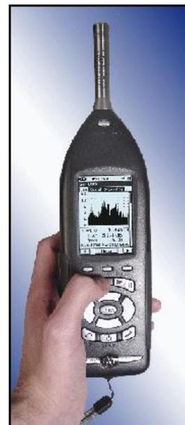
Inoltre si è utilizzato anche un Fonometro Integratore Real-Time **LARSON&DAVIS** tipo **SOUNDTRACK LxT**, conformi alle **Classe 1** di precisione e alle norme **IEC 60651-2001, IEC 60804, IEC 61672-2002, IEC 61260-2001, IEC 61252-2002 (Classe 1)**, aventi mat. n° **2852**, dotato di microfono a condensatore da ½" **PCB** tipo **377B02** avente mat. n° **124125**
