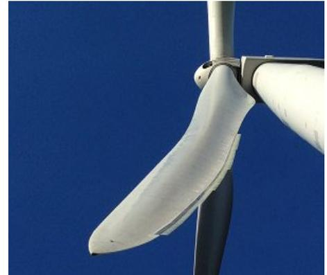
Ciascuna pala è dotata, di un sistema di protezione antifulmine, munito di ricettore che convoglia l'energia verso il circuito di messa a terra della macchina al fine di salvaguardare la sicurezza e lo stato delle apparecchiature.
