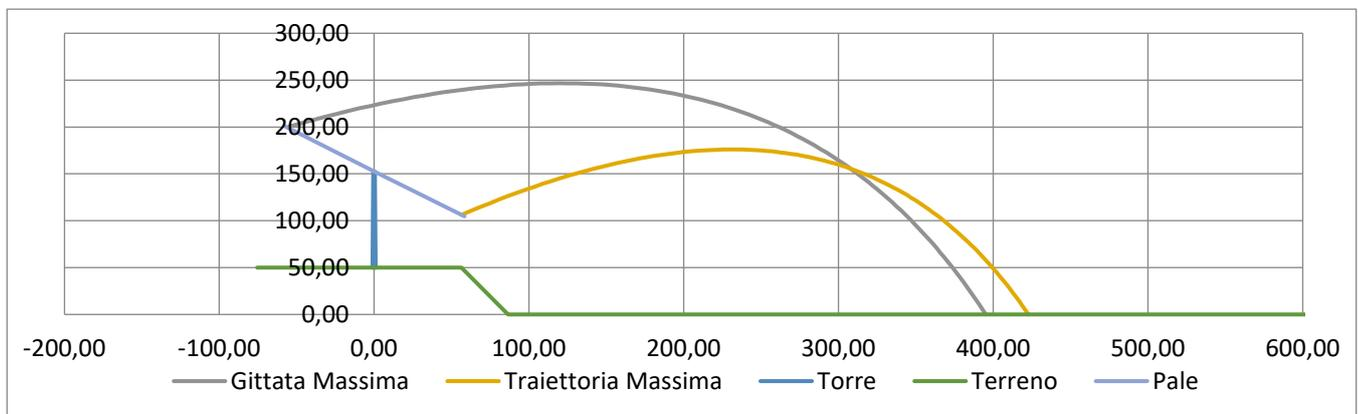
Figura 3 - Traiettoria del moto di un frammento di 5 m, a seguito di rottura
