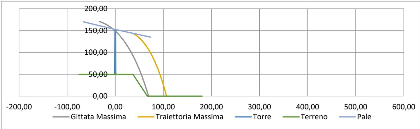
*Figura 2 - Traiettoria del moto della pala intera, a seguito del distacco*
