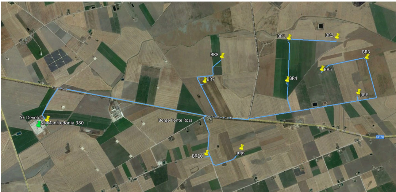
Figura 30 Rappresentazione grafica generale del cavidotto
