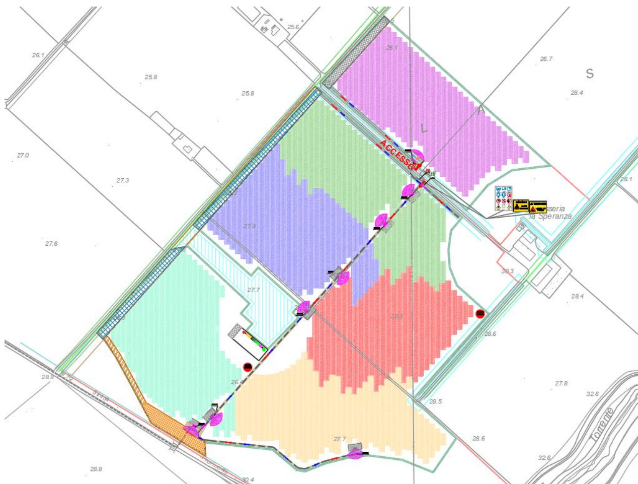
Figura 20 Layout di cantiere – Aree d’impianto ad ovest
