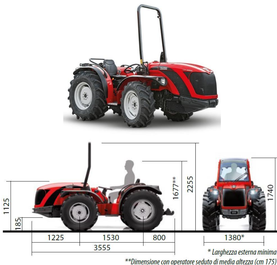
Figura 26 – Esempio di trattore da frutteto che potrà essere adoperato per le operazioni colturali Fonte: https://www.antonio carraro.it/it/catalogo/tgf
