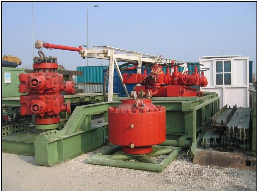
La testa pozzo si completa con almeno una valvola laterale, installata sotto al BOP ed alla eventuale valvola maestra, a sua volta collegata ad una tubazione che permette di pompare fluido in pozzo per controllare la pressione in caso di necessità o gestire nella maniera voluta eventuali emissioni di fluido dal pozzo stesso.
