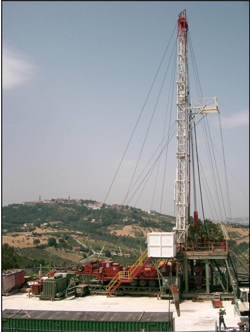
In *Figura 3.3.3.3b* è riportata una foto di un tipo di impianto moderno, molto compatto, idoneo a raggiungere agevolmente la profondità massima dei pozzi reiniettivi.
