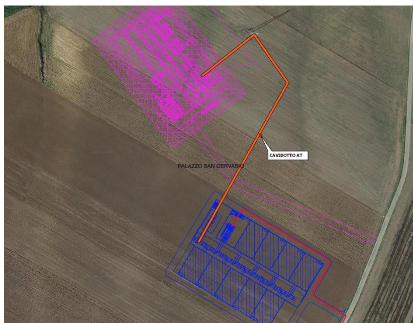
Inquadramento su Ortofoto – Cavidotto di Connessione aggiornato
