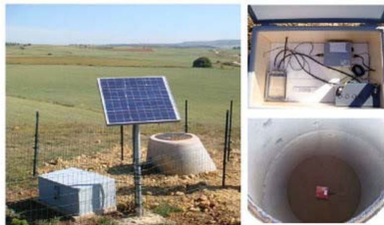
Fig. 5. Stazione sismica tipo.
