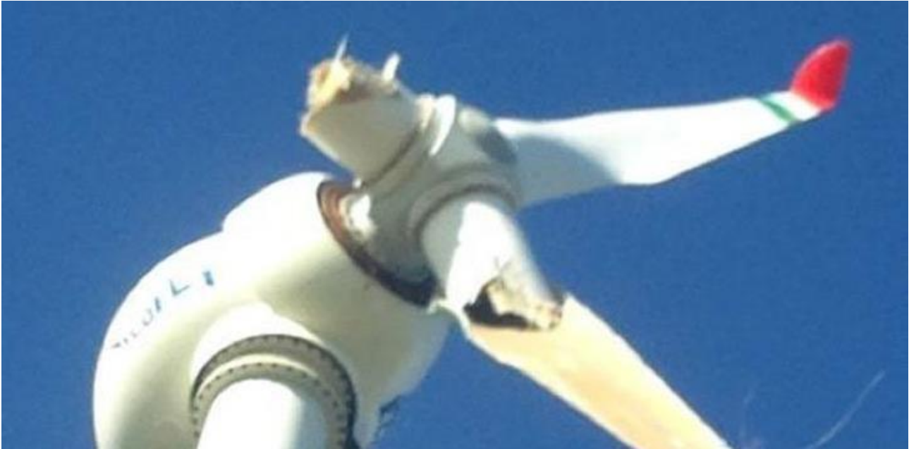
Figura 5- Esempio di rottura alla radice
