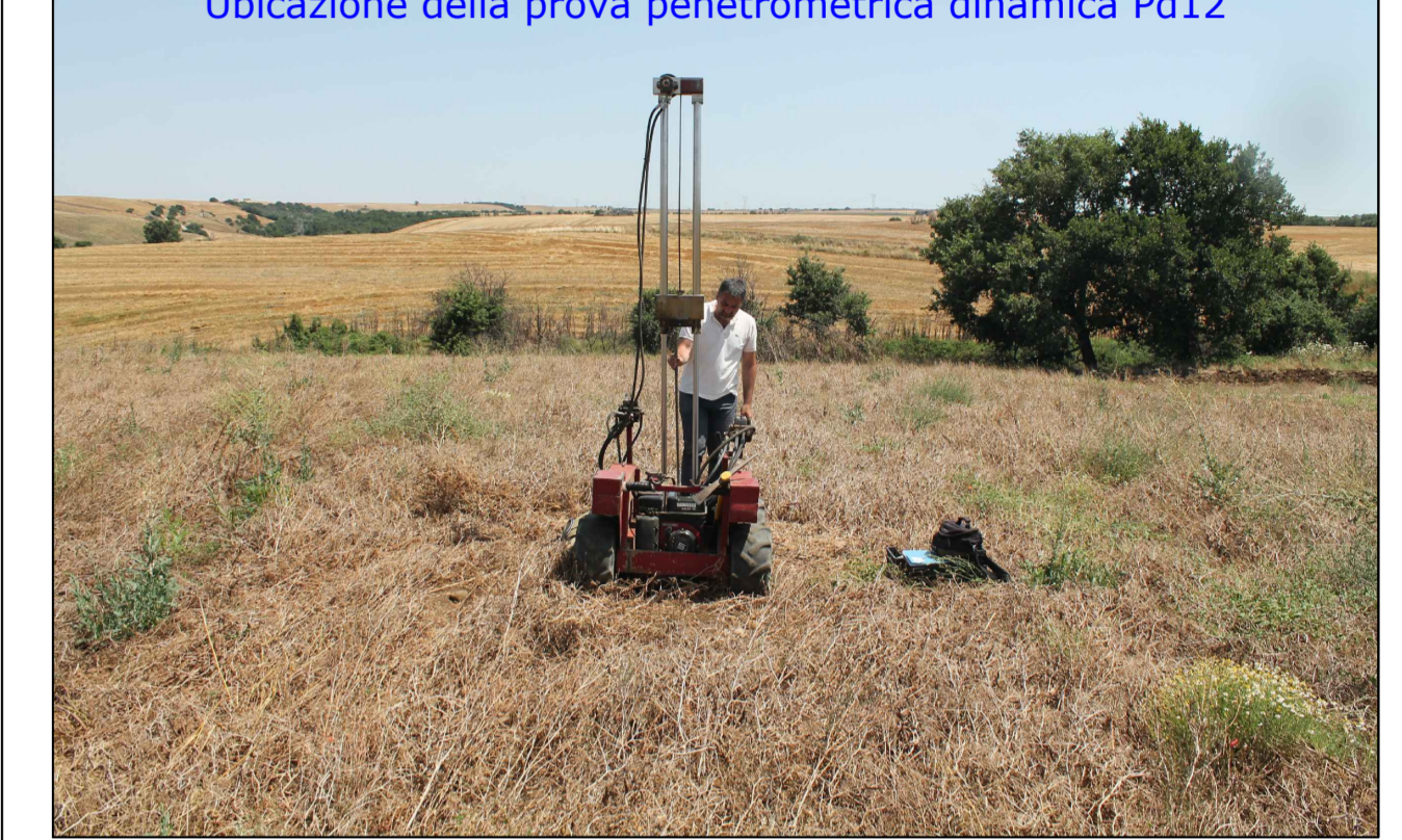
Ubicazione della prova penetrometrica dinamica Pd12
