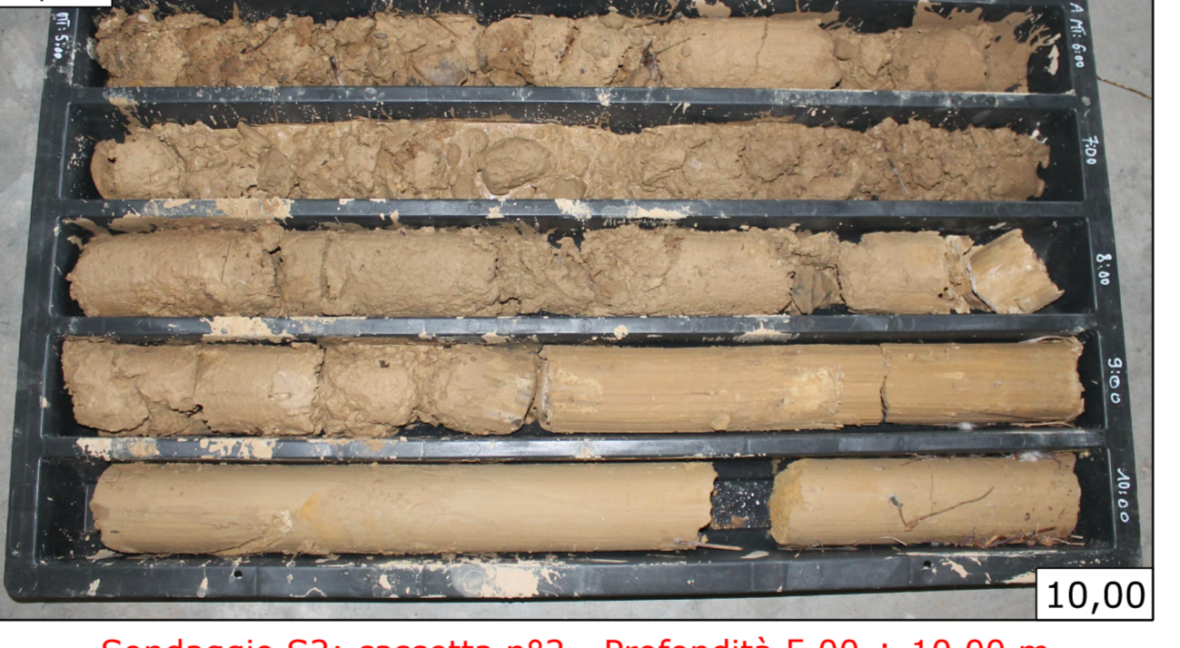
Sondaggio S2: cassetta n°2 - Profondità 5,00 ÷ 10,00 m
