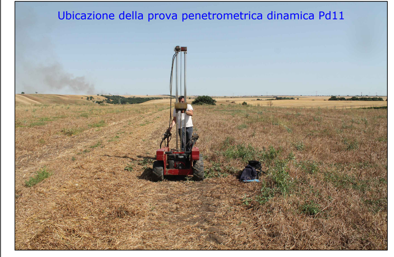
Ubicazione della prova penetrometrica dinamica Pd11
