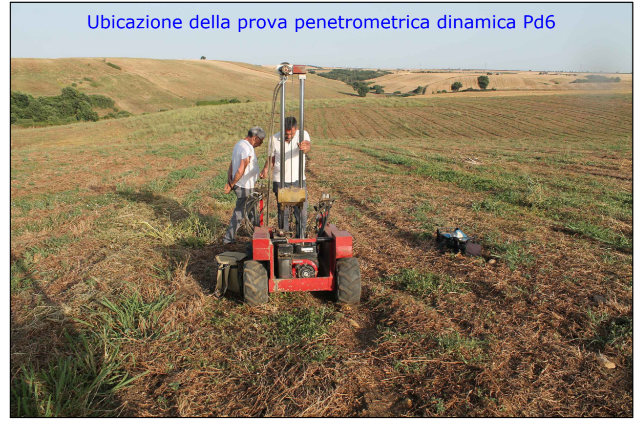
Ubicazione della prova penetrometrica dinamica Pd6
