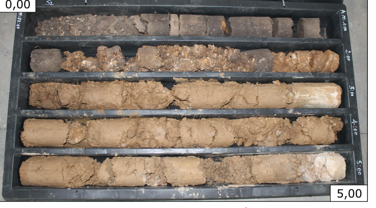
Sondaggio S2: cassetta n°1 - Profondità 0,00 ÷ 5,00 m
