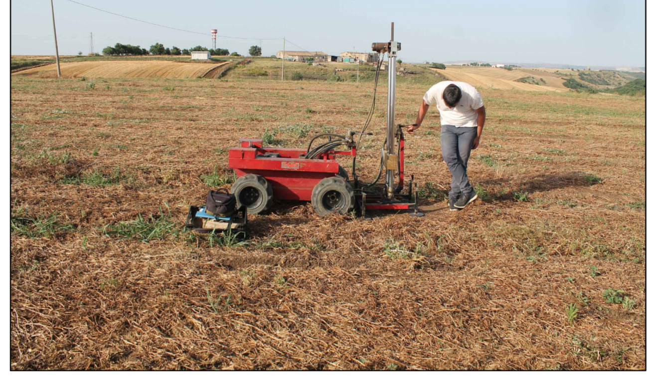
Ubicazione della prova penetrometrica dinamica Pd7
