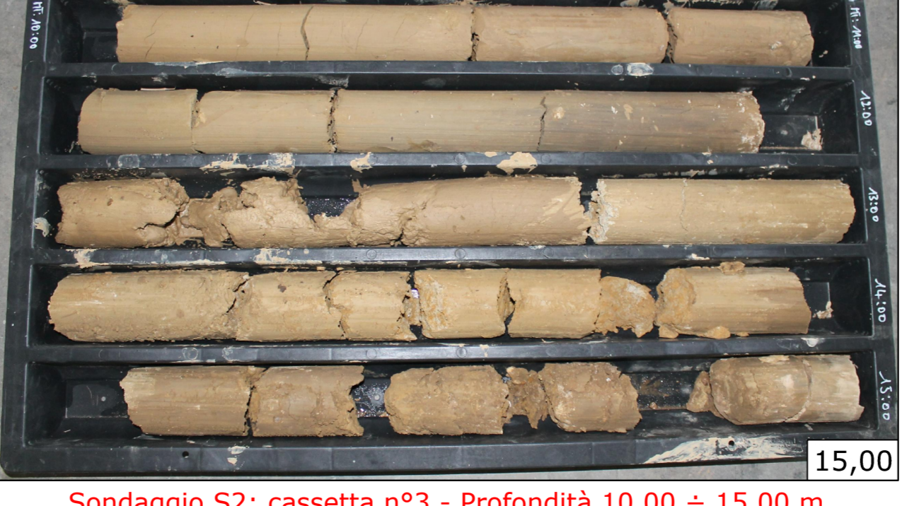
Sondaggio S2: cassetta n°3 - Profondità 10,00 ÷ 15,00 m
