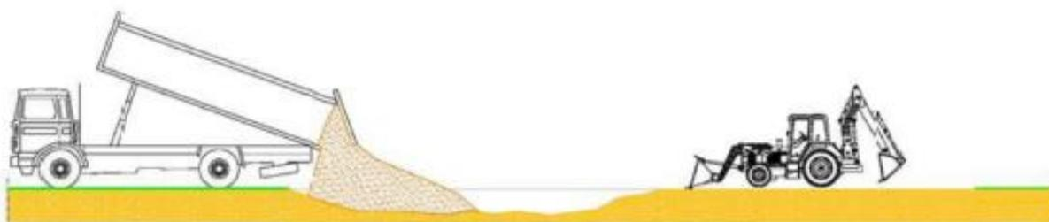
Riempimento delle poche trincee scavate per la rimozione delle opere di sottofondazione con terreno vegetale.
