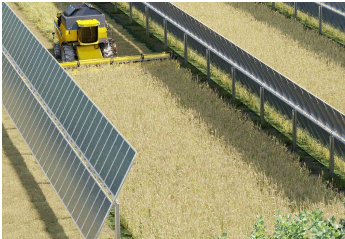
Particolare inseguitore monoassiale
