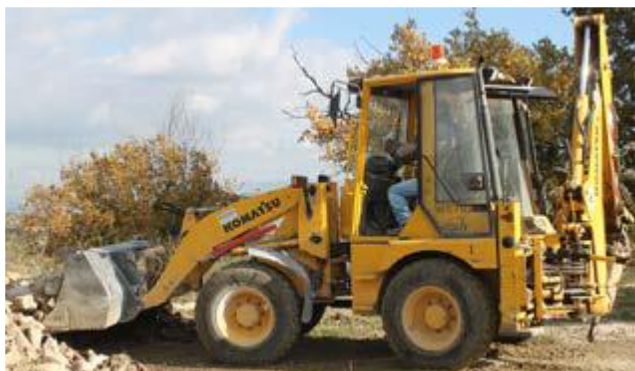
Escavatore caricatore (Terna)
