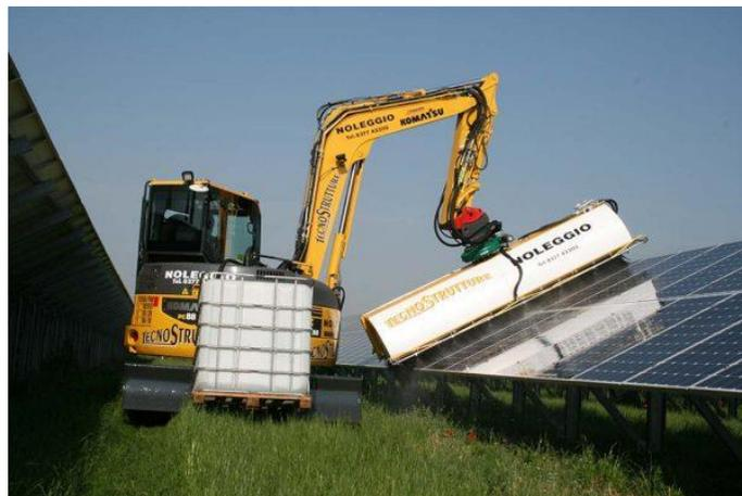
*Esempio di sistema di lavaggio moduli fotovoltaici*
