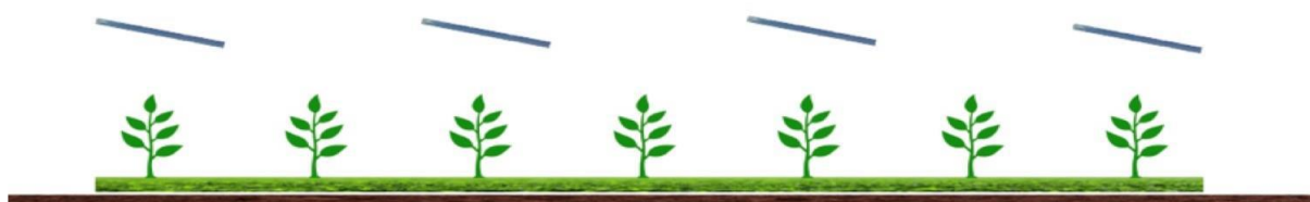
Sistema agrivoltaico in cui la coltivazione avviene tra le file dei moduli fotovoltaici, e sotto a essi (TIPO 1).
