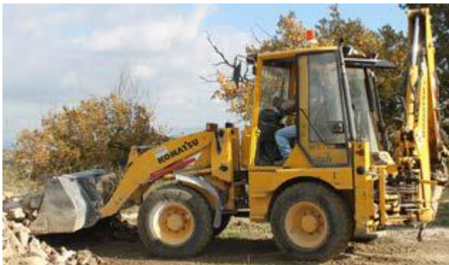
Escavatore caricatore (Terna)
