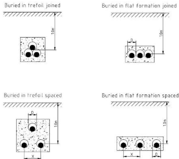
I cavi verranno posati con una protezione meccanica (lastra o tegolo) ed un nastro segnalatore ad una distanza non inferiore a 20 cm dalla protezione meccanica o dal cavidotto. Su terreni pubblici e su strade pubbliche la profondità di posa dovrà essere comunque non inferiore a 1,2 m previa autorizzazione della Provincia. I cavi verranno posati in una trincea scavata a sezione obbligatoria.
