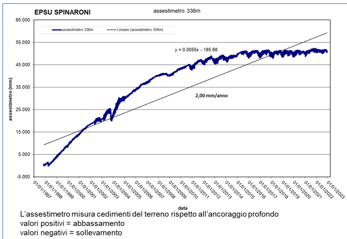
Figura 7B - Serie storica delle misure assestimetriche nella stazione EPSU di Spinaroni
