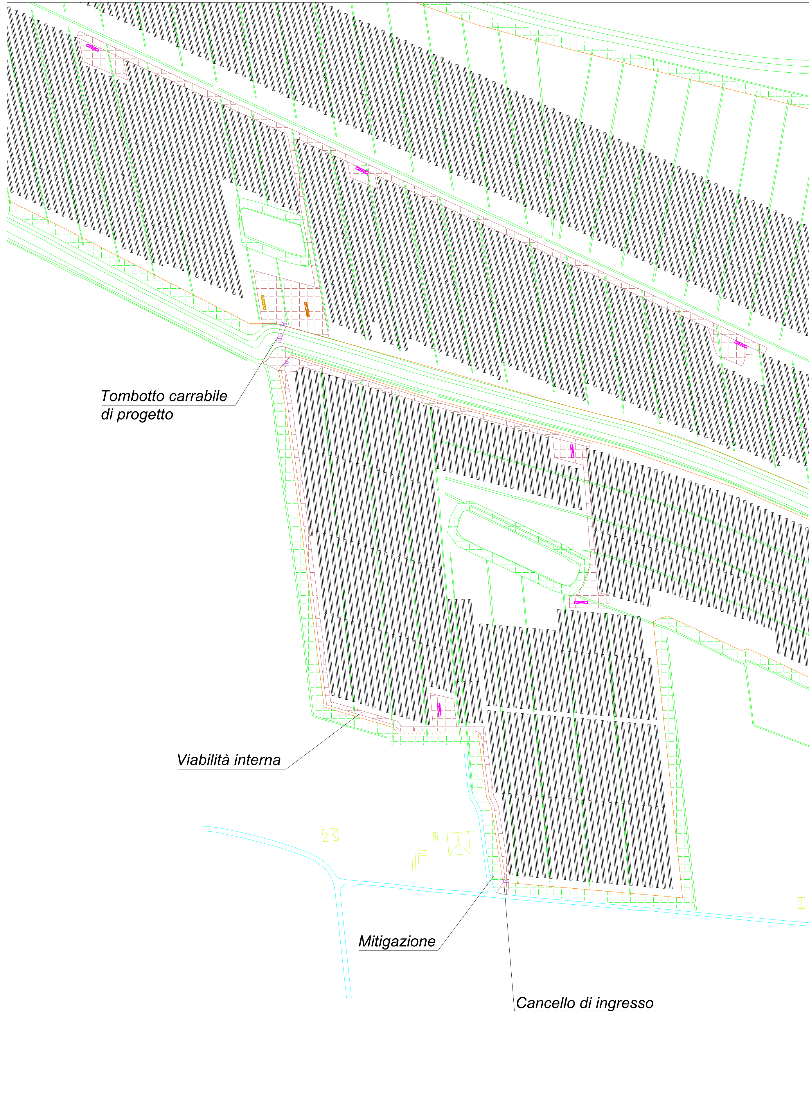
Dettaglio accesso e viabilità lotto Sud - Scala 1:2000
