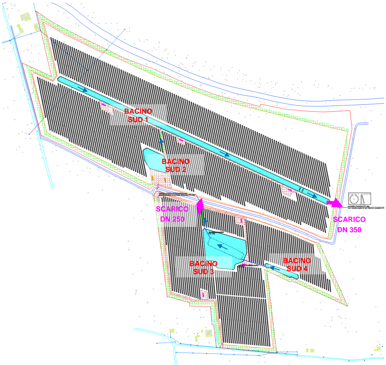
Figura 5.3 - Schema impianto drenaggio acque meteoriche AREA sud
