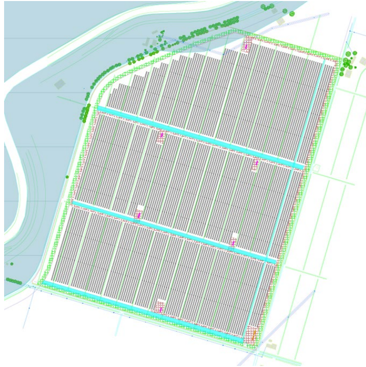
Figura 1 - Layout campo Nord dell'impianto fotovoltaico
