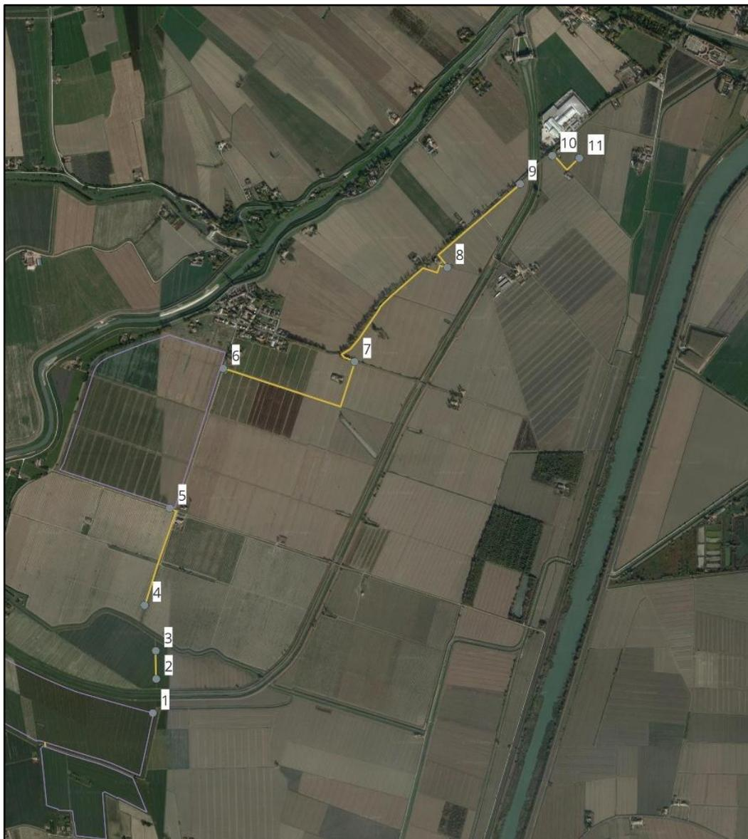
Figura 3– Tracciato posa cavidotto 36 kV con individuazione delle diverse tratte
