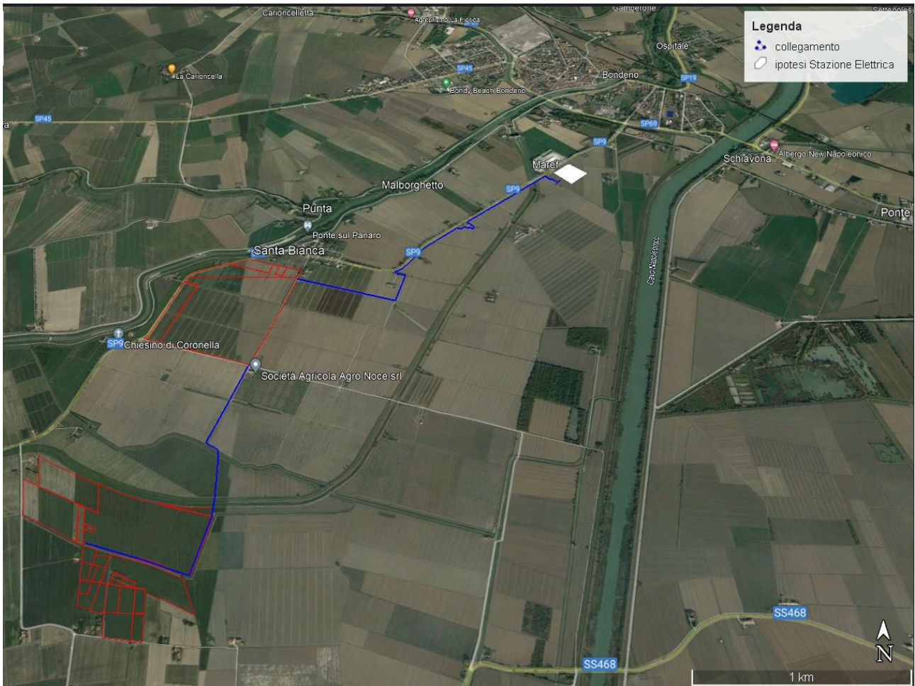
Figura 12 - Area del progetto in esame; in rosso l'impianto agrovoltaiico, in blu il cavidotto e in bianco l'ipotesi della stazione Elettrica
