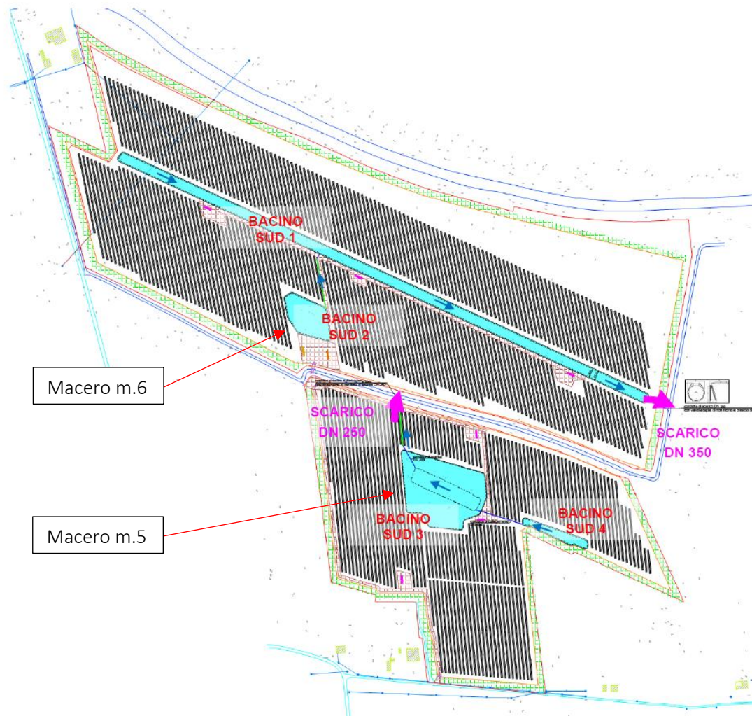
Figura 35 - Schema impianto drenaggio acque meteoriche AREA sud. In riferimento al macero m.5 le linee tratteggiate indicano le dimensioni attuali mentre l'area in azzurro le dimensioni del progetto
