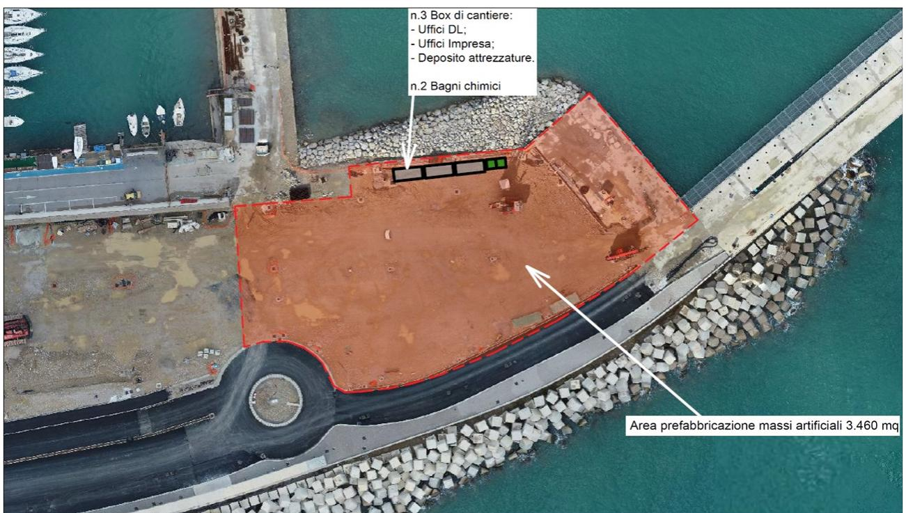
Figura 7 - Porto di Termini Imerese: area di prefabbricazione e deposito massi artificiale
