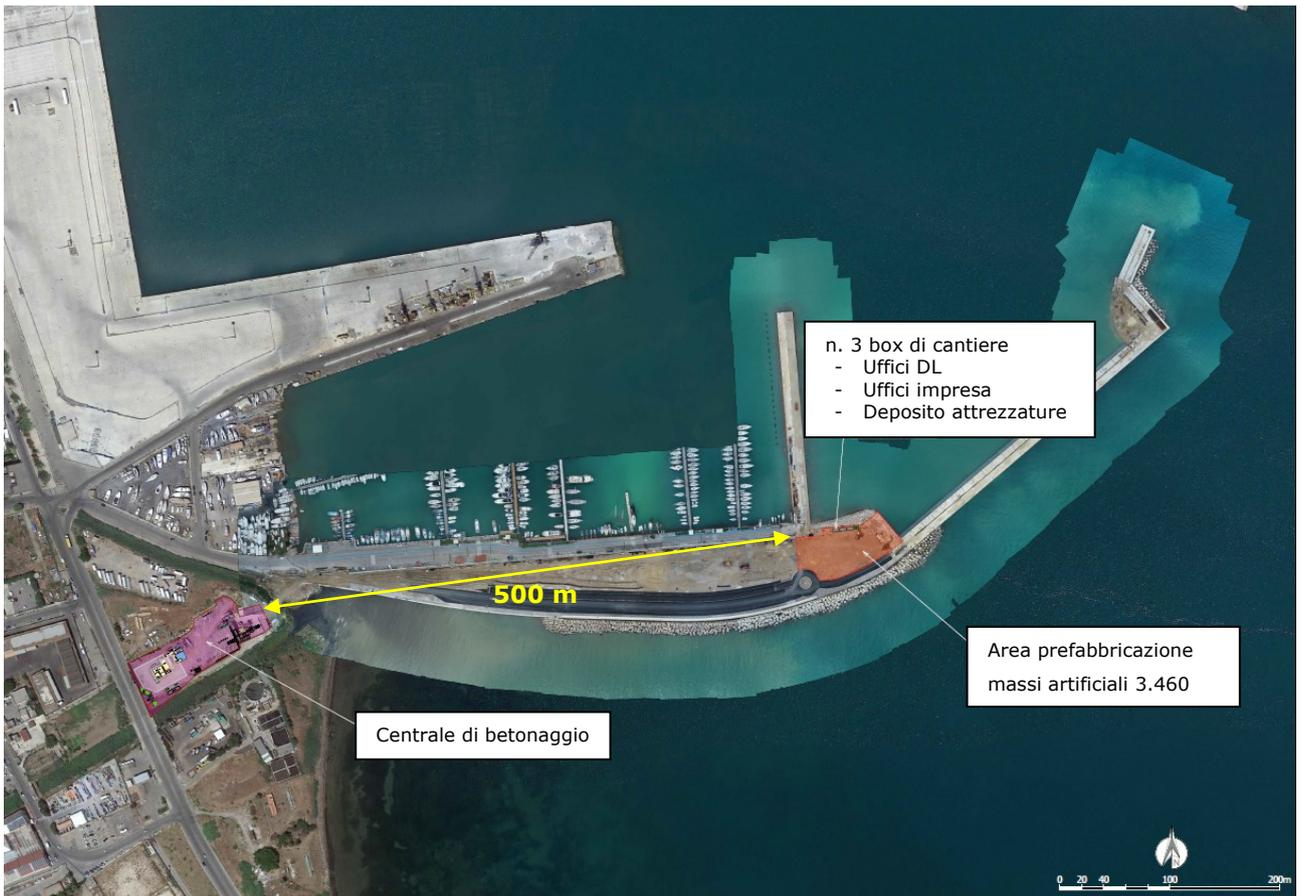
Figura 6 - Porto di Termini Imerese: ubicazione area di cantiere e impianto di produzione di calcestruzzo
