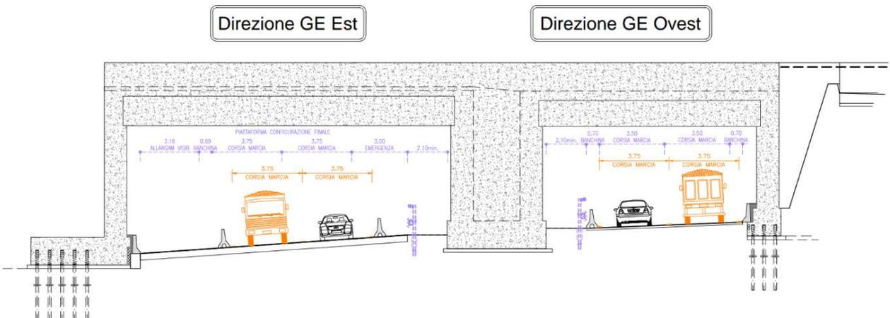
Figura 22 – Galleria artificiale Torbella – Sezione trasversale della carpenteria generale del progetto approvato
