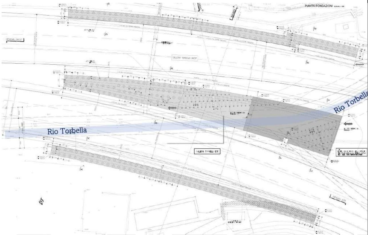
Figura 23 – Pianta fondazioni della galleria artificiale Torbella nella configurazione del progetto di modifica
