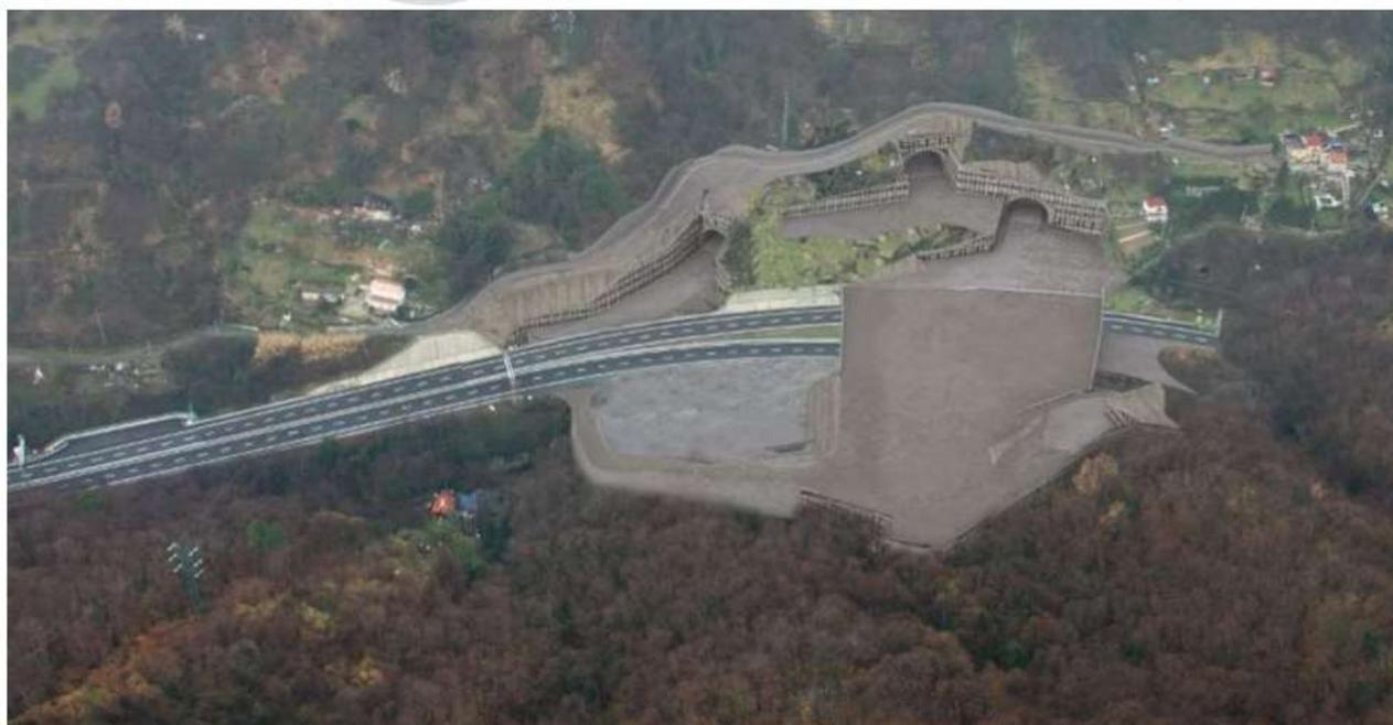
*Figura 2 Foto simulazione del progetto approvato di cantierizzazione dell'interconnessione tra l'A7 e l'A12 a Torbella, atta a rappresentare il cantiere di imbocco situato in corrispondenza della Val Torbella immediatamente ad Ovest delle gallerie Montesperone*
