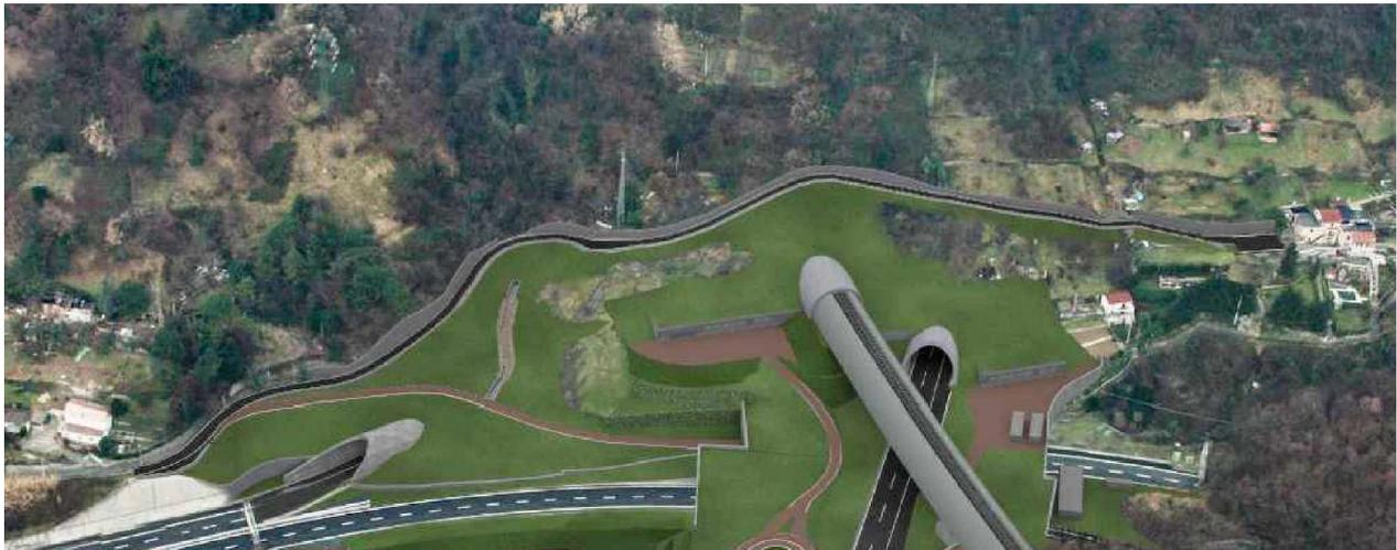
Figura 32 Vista frontale - Foto simulazione realistica del progetto approvato di sistemazione definitiva delle aree di imbocco situate in corrispondenza della Val Torbella immediatamente ad Ovest delle gallerie Montesperone - Deviazioni viabilità interferita via Torbella a monte degli imbocchi realizzata con incisioni del versante sostenute da paratie di micropali rivestite
