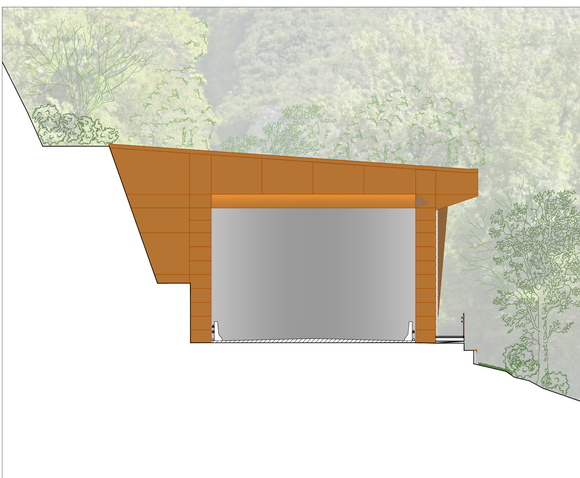
GALLERIA PARIETALE - PROSPETTO IMBOCCO - rapp. 1:100
