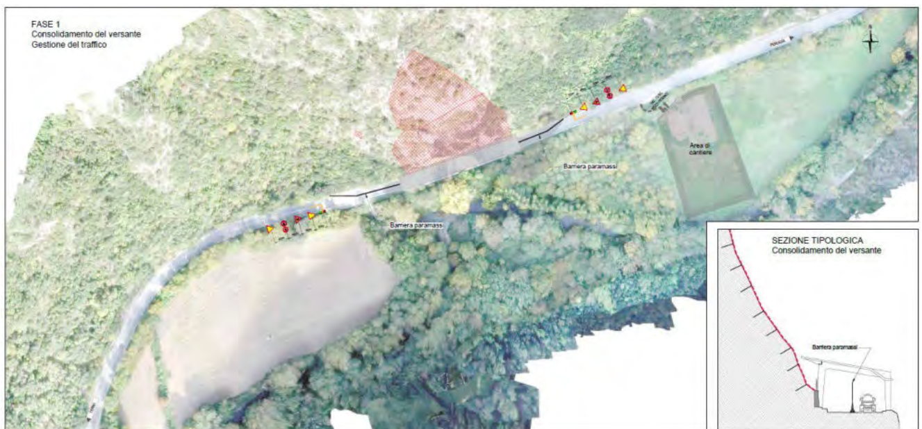
Fig. 6 – Fase 1: consolidamento del versante a monte della galleria esistente
