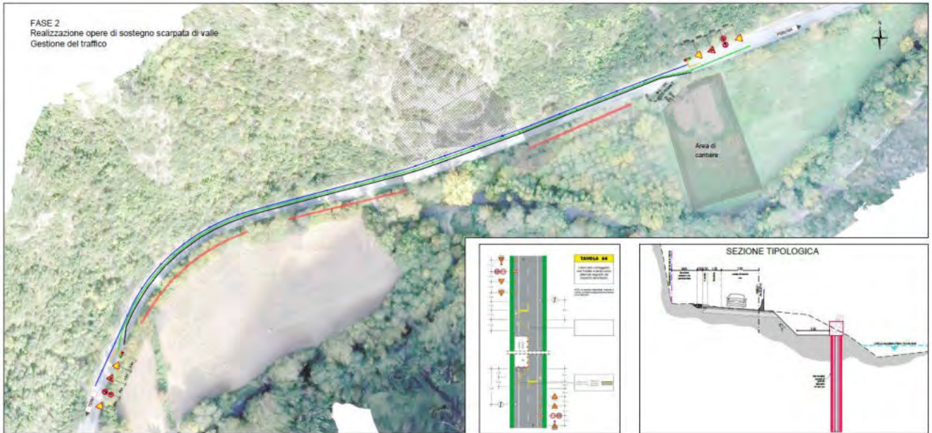
Fig. 9 – Fase 2: realizzazione paratie di pali lato valle della viabilità in allargamento
