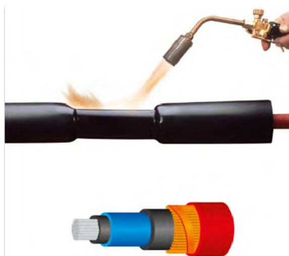
Schema di esecuzione di un giunto MT
