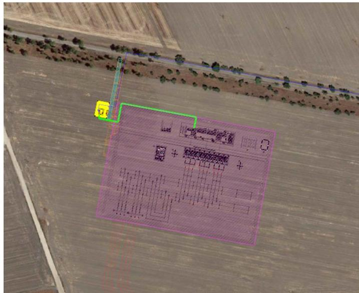
**Fig. 3.** Inquadramento su ortofoto delle opere di Rete: in blu, l'elettrodotto dorsale MT 36kV; in giallo cabina di sezionamento Produttore; in verde, l'elettrodotto 36kV per il collegamento alla nuova SE Satellite 36/380kV Terna; riquadrata in viola, la posizione della nuova SE satellite 36/380 kV.
