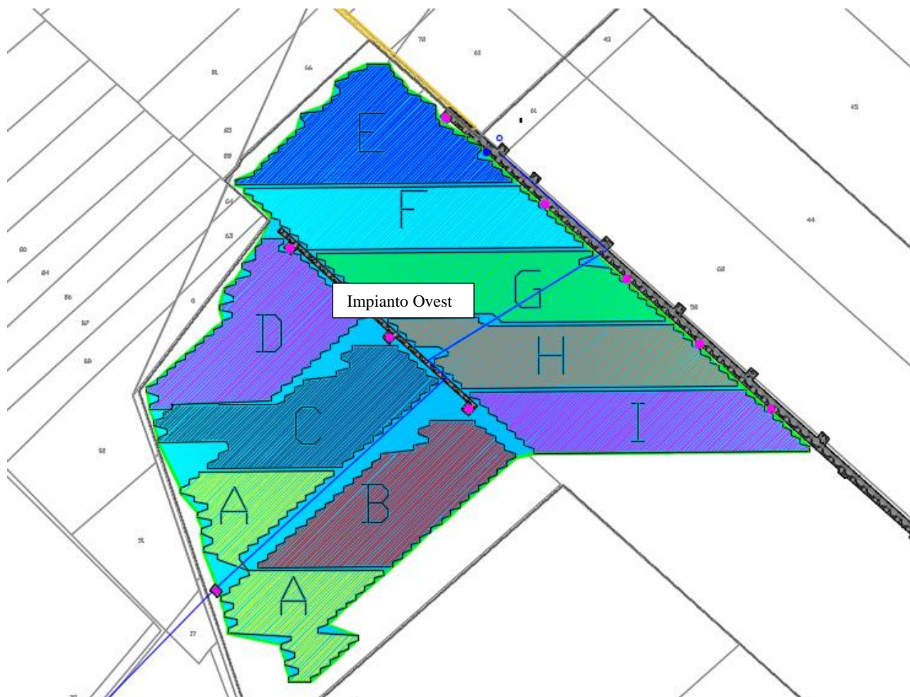
Fig. 8. Layout del SottoImpianto "Ovest" con identificazione dei vari subcampi (da A a I); in magenta, la posizione delle Stazioni di conversione/trasformazione; in blu, la posizione della cabina master "cabina di Raccolta Ovest".
