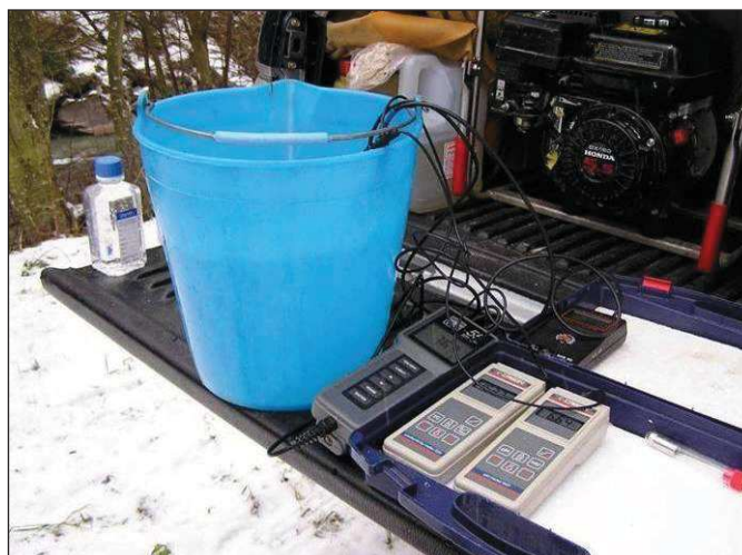
Foto 3.1 – Set di strumenti per misurazione dei parametri chimico-fisici di campo
