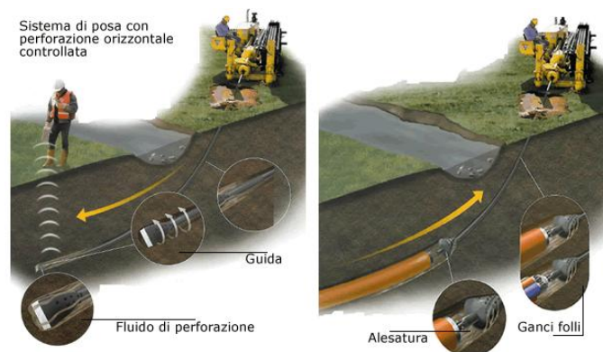
Figura 12: Posa in opera tubazione per alloggiare cavi
